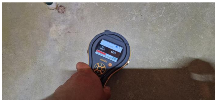
605 av maks 999 ved fuktsøk å gulv i bod. Det kan bemerkes at vi har hatt en lengre tid med tørt og fint vær.
