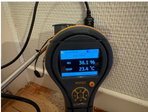
Måling av relativ luftfuktighet.
