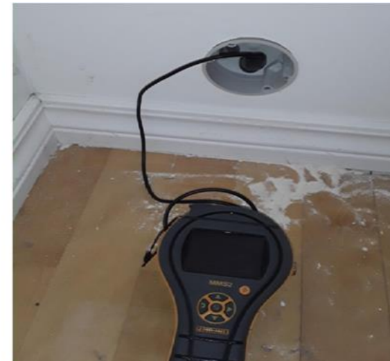
Våtrom - [Hulltaking og fuktmåling fra tilstøtende rom til bad i loftsetasje - Soverom]
