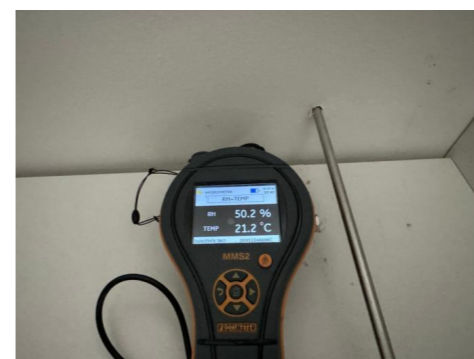
Måling av relativ luftfuktighet.
